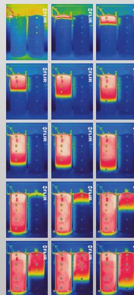
Ces images par caméra thermique démontrent la stratification de l'énergie durant le remplissage des ballons.
