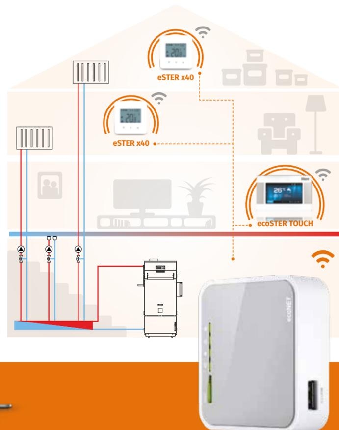
Accéder au régulateur à distance est possible à partir de tout périphérique connecté sur Internet, que ce soit une tablette, un ordinateur ou un téléphone portable. Le paramétrage se fait via un navigateur Web sur [www.econet24.com](http://www.econet24.com) ou via une application mobile disponible pour Android et iOS.
