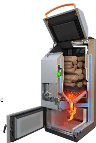
**Chaudière Bûches** by BLAZE HARMONY - Norme NF EN 303.5 - Classe 5 - Classe énergétique A+ - Ecodesign - Equivalent 7\* Flamme verte - Rendement supérieur à 91%
