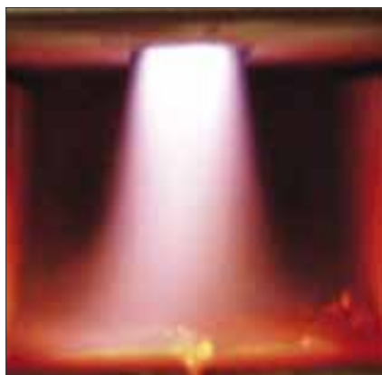
combustion complète des gaz de bois dans la chambre de combustion inférieure
