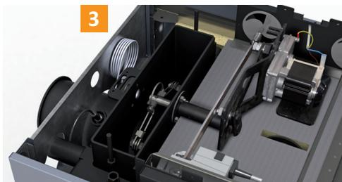
Nettoyage automatique des échangeurs thermiques
